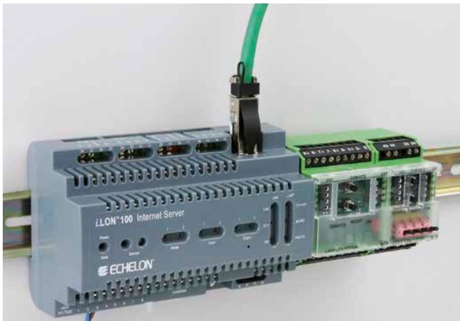
Bild 4: Direktanschluss in der Gebäudeautomation
