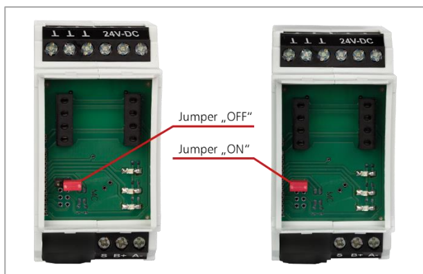
Abbildung 18 Passwort-Jumper
