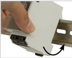
Abbildung 1 Montage des MR-GW
